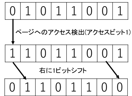
図 7 エージングアルゴリズムを用いたメモリアクセス履歴の管理
